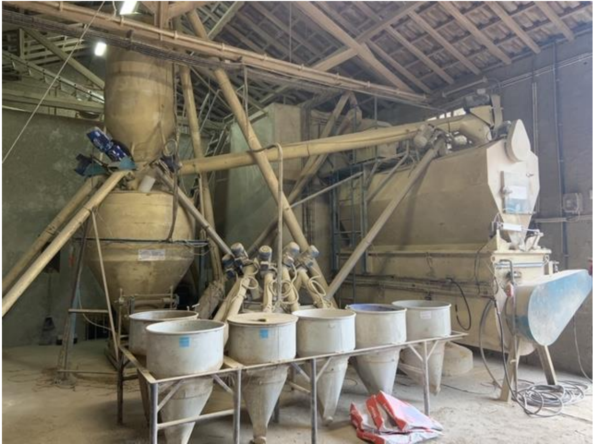
Ffigur 4. Y felin arbenigol ar Fferm 1. Defnyddir yr hopys bach i ychwanegu cynhwysion allweddol eraill at y gymysgedd.
