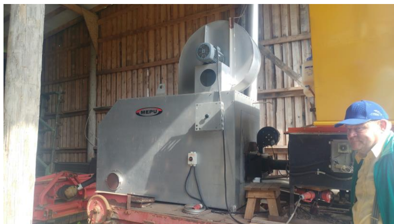
Mae sychu yn rhan hanfodol o dyfu cnydau yn y Ffindir ac mae'n aml yn broses ddurd iawn. Dyma sychwr cartref sy'n llosgi sglodion pren.
