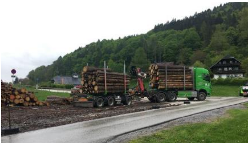
Pren a gafodd ei echdynnu gan graenïau o sawl safle yn cael ei gludo i iard graddio ar lori.
