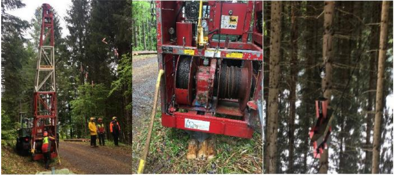
Craen ceblau canolig ei faint â thŵr a chludydd uwchlinell sy'n cloi.
