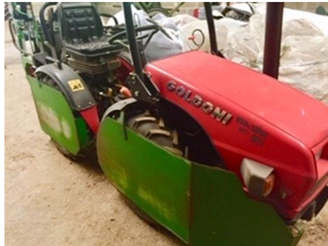
Tractor coedwigaeth Goldoni gyda giardiaiu ychwanegol er mwyn atal difrod gan goed.
