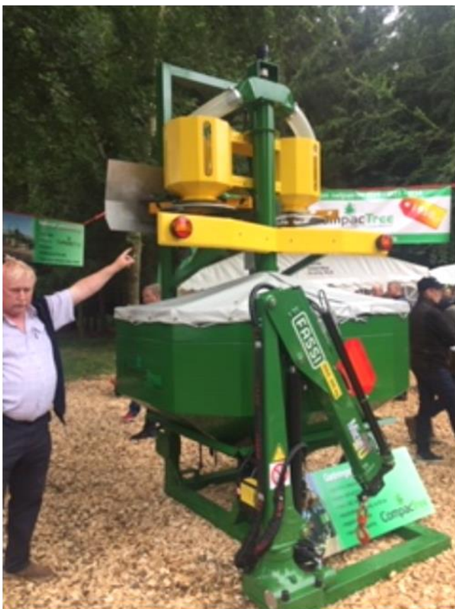
Taenwr gwrtaith gyda disgiau ar ei ben er mwyn mynd dros ben y coed.
