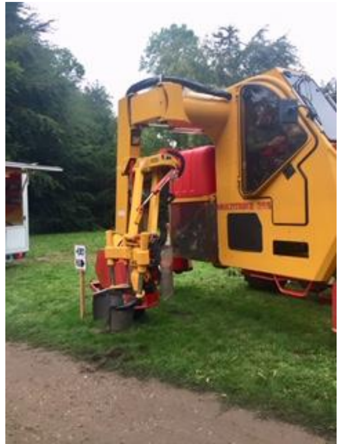
Tractor nenbont coed arbenigol gyda pheiriant er mwyn tynnu coed i'w potio.
