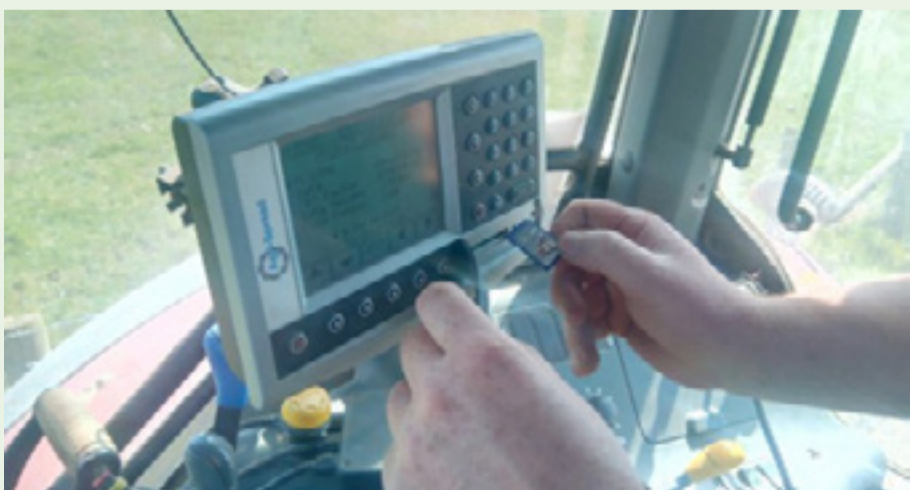
Ffigwr 2: Trosglwyddo'r data mapio'r tir i system GPS y tractor ar gerdyn SD.
