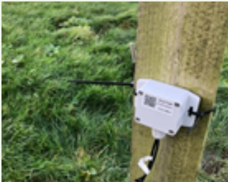
Ffigur 2. Synwrydd tymheredd deuol wedi'i osod ar bostyn yn un o'r padogau
