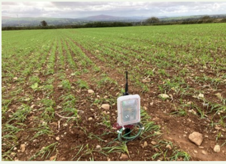
Ffigwr 3: Set o synwryddion nitradau, tymheredd a lleithder pridd gyda throsglwyddydd LoRaWAN.
