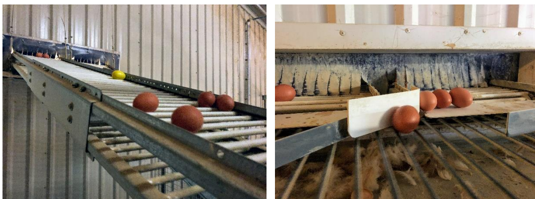
Ffig 9 a 10. Yr ardal rhwng y belt trosglwyddo i'r man trosglwyddo croes i mewn i'r ardal becynnu
