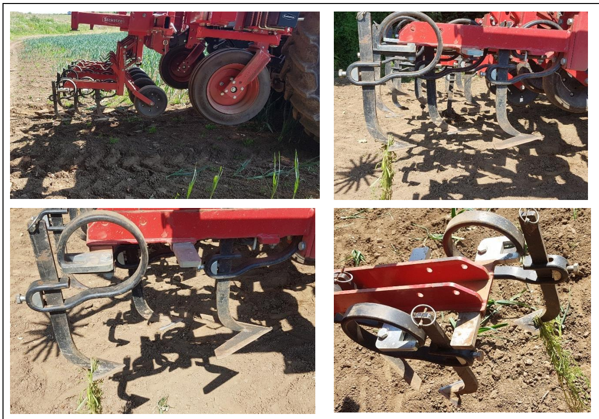
Ffigwr 8. Chwynwr robotig mewn cnwd cennin. Amrywiol enghreifftiau o'r llafnau yn codi chwyn.
