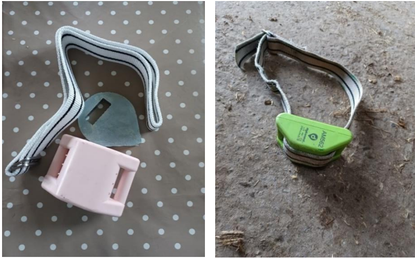
Ffigwr 8: Coleri Digitalanimal a ddefnyddiwyd ar wartheg a defaid. Mae'r llun ar y chwith hefyd yn dangos y pwysau oedd ar gael i'w roi ar y goler i roi'r cynnyrch mewn lleoliad gwell ar ddefaid.
