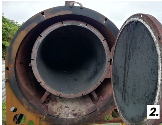
1. Glaswellt y gweunydd (mholinia caerulea) yn tyfu ar dir uchel. 2. 'Oxford Retort' a ddefnyddiwyd gan Tony Davies i gynhyrchu bio-olsg ar gyfer yr arbrawf. 3. Ychwanegu bio-olsg i'r pridd ar fferm William Robert. 4. Strwythur bio-olsg o dan ficrosgop electron sy'n dangos arwynebedd uchel a chapasiti i ddal dŵr.
