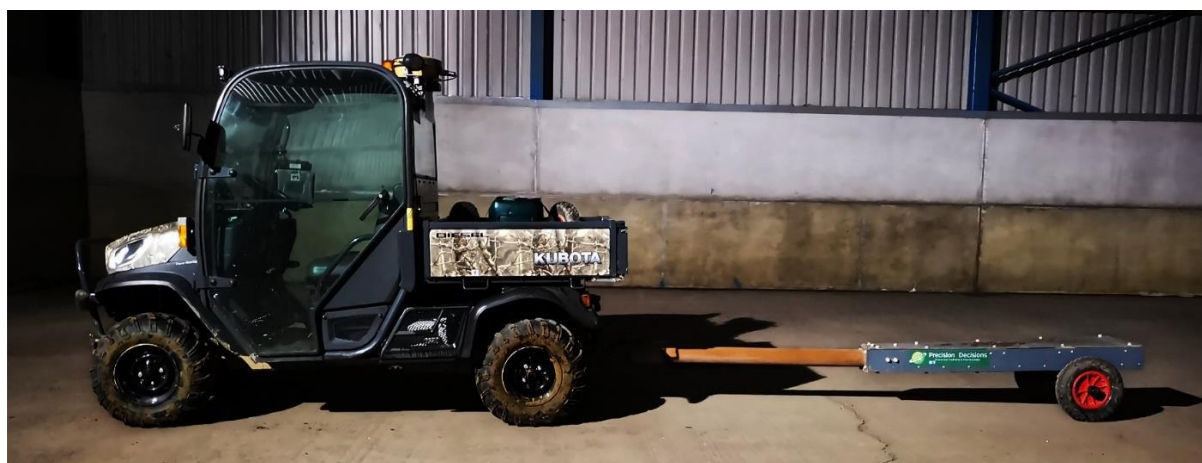
Ffigur 1: Cerbyd Kubota RTV gydag arweinydd llywio awto GPS a synhwyrdd dargludedd electromagnetig .
