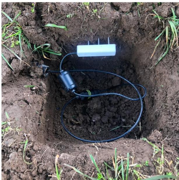
(Chwith) Synhwrydd pridd (Dde) Synwryddion tymheredd a glawiad
