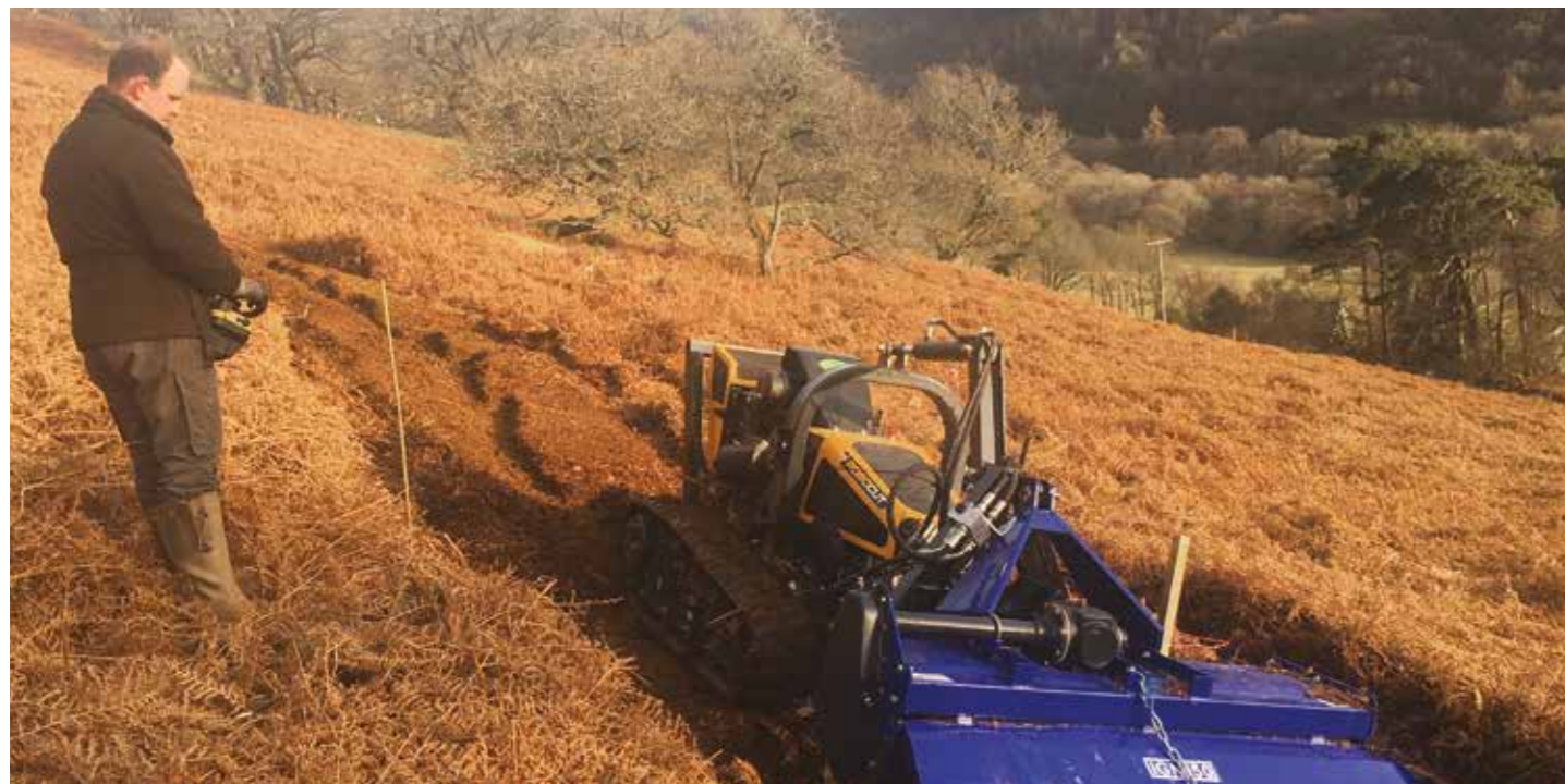
Y peiriant Robocut gydag offer tyrchu yn sownd wrtho sy'n cael ei reoli o bellter
