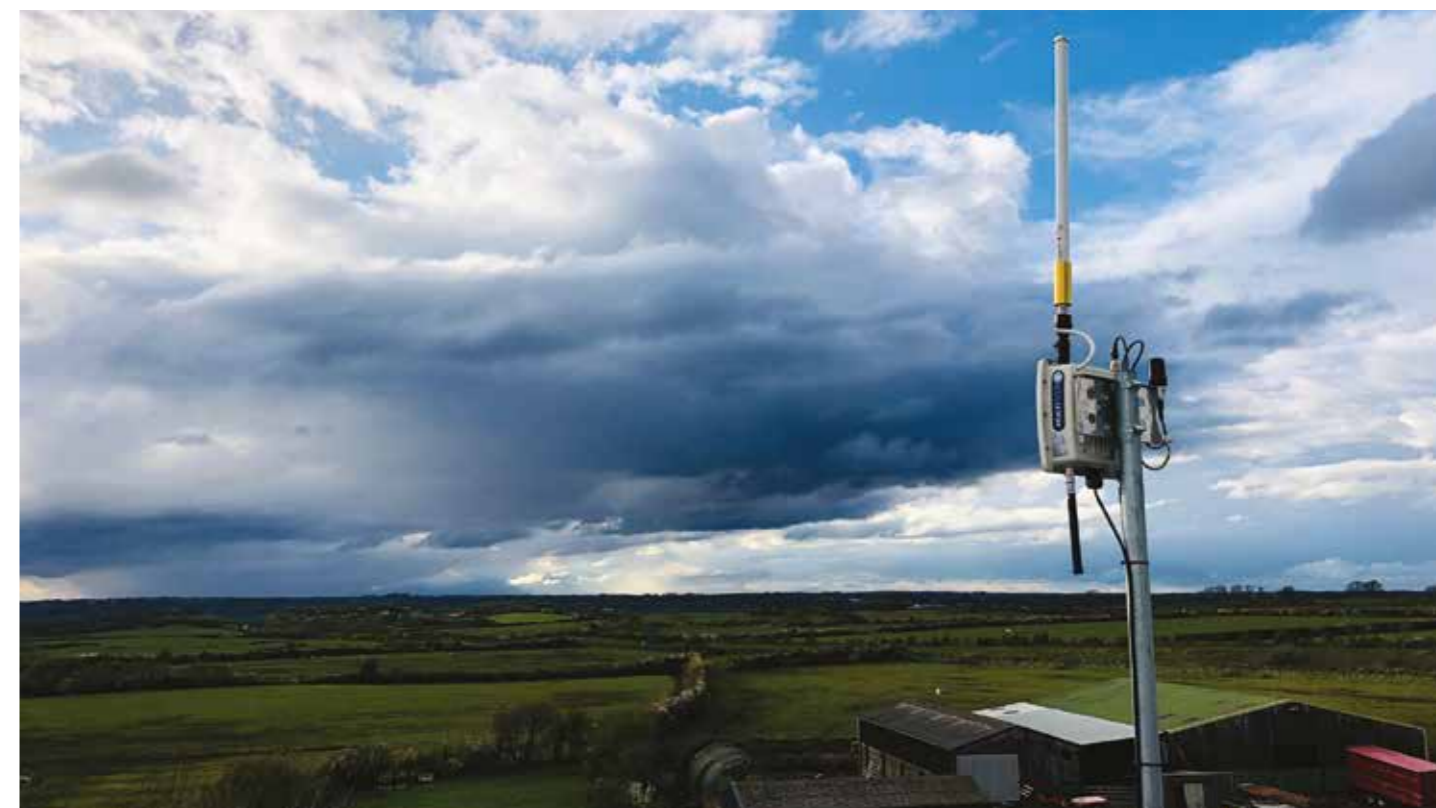
Porth LoRaWAN a ellir cael ei osod tu allan, ar do sied er enghraifft.
