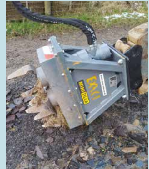
Yr offer tyrchu (rotovator) ar gyfer y tyrchwr bach
