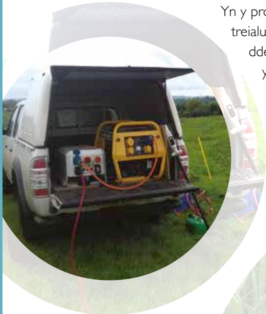
Mae'r peiriant Rootwave Pro yn defnyddio generadur petrol a phicell gyda chebl hir (~20m).
